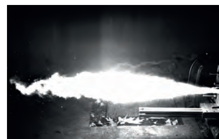
Высокоскоростная видеосъемка при огневых испытаниях жидкостных ракетных двигателей
